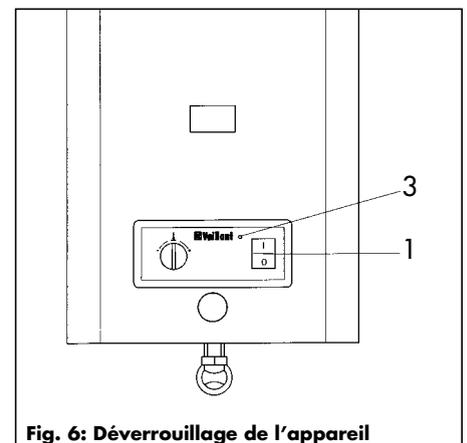
Fig. 6: Déverrouillage de l'appareil
