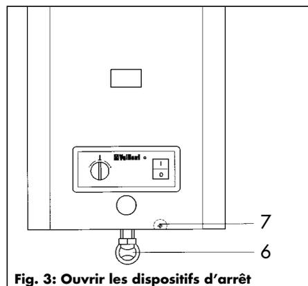
Fig. 3: Ouvrir les dispositifs d'arrêt
