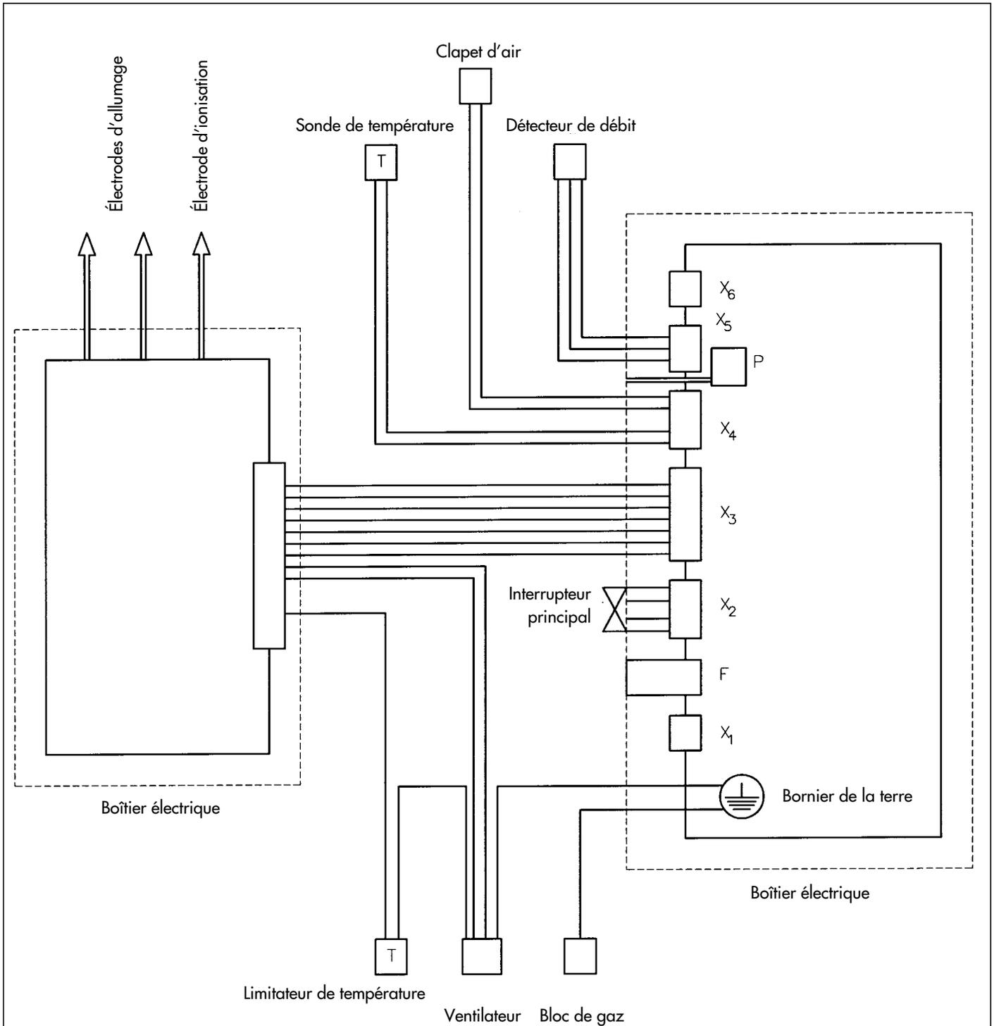
Fig. 18: schéma de câblage
