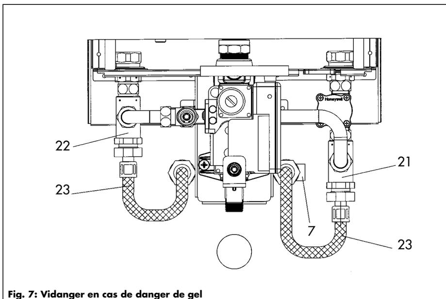
☞ Lors du remplissage ultérieur, ne remettre votre appareil en service que si après l'ouverture du robinet d'arrêt d'eau froide (7) de l'eau s'écoule à nouveau aux points de puisage d'eau chaude raccordés. Ainsi, vous pourrez être sûrs que le chauffe-bain Vaillant est bien rempli d'eau.
