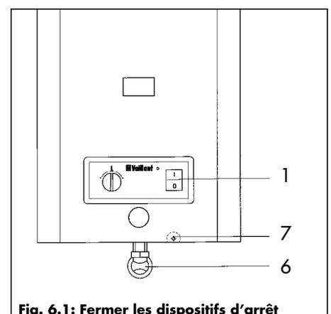
Fig. 6.1: Fermer les dispositifs d'arrêt
